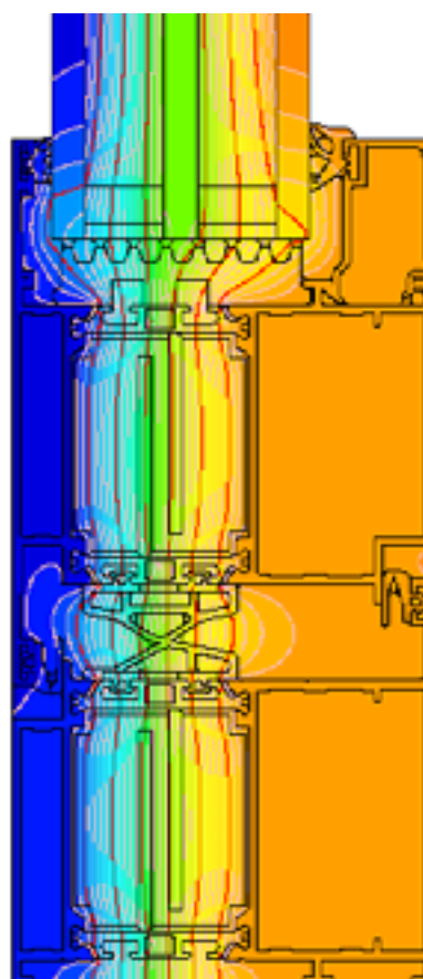
przykładowy rozkład izoterm dla złożenia ościeżnicy i skrzydła drzwiowego systemu GN 75 (GN414 + GN425)
